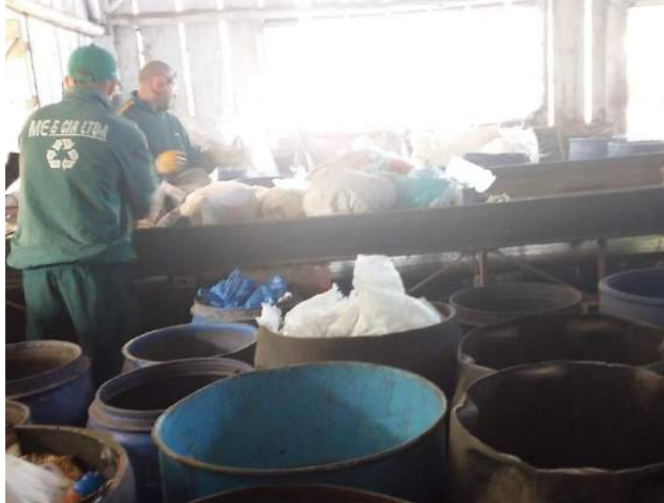
Figura IV.166 - Utilização de esteira para separação dos materiais
